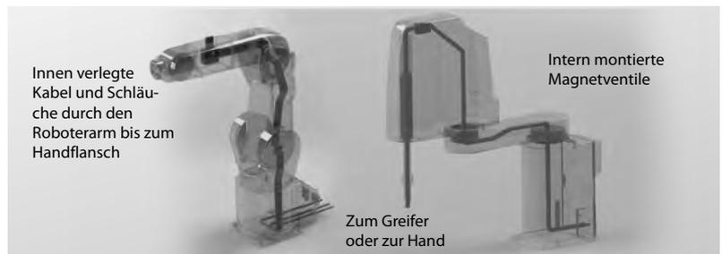
**Flexibilität durch interne Ethernet-Kabelanschlüsse**
