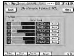
Menü zur Überwachung der Wartungsintervalle
