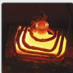
Eine Variante der Wärmebehandlung von Metallen ist das Induktionshärten. Die angestrebte Gefügestruktur des Metalls ist abhängig von einem optimalen Temperatur-Zeit-Verlauf.
