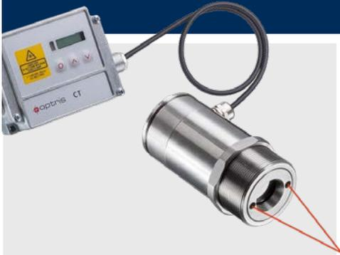
Wenn Sie wissen, wo sich in Ihrer Anwendung der kritische bzw. zu messende Bereich befindet, sollte ein **punktuell messendes Infrarot-Thermometer** zum Einsatz kommen. Die Messobjektgröße bestimmt dabei, welche Optik beim Messgerät gewählt wird. So ist es Ihnen möglich, die Temperatur exakt zu überwachen und gegebenenfalls den Prozess zu optimieren – bevor es zu Qualitätsproblemen kommt.
